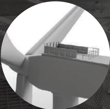
Naceles de turbina eólica
