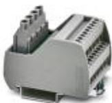
Módulo VARIOFACE, com 2 trilhos de potencial (P1, P2) para distribuição de potencial, para montagem sobre trilhos de fixação NS 35. Largura do módulo: 70,4 mm
